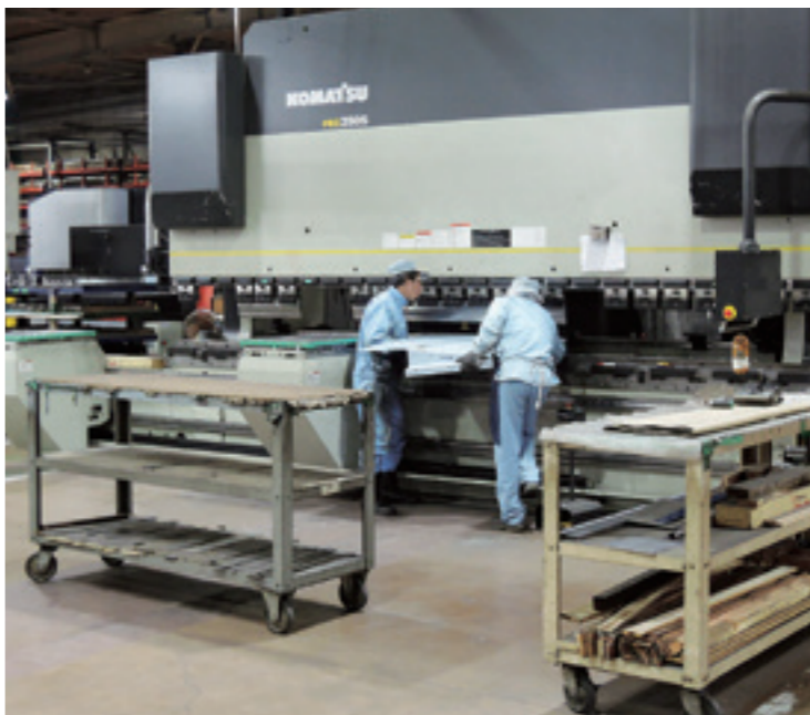
曲げ加工に用いる5m幅のプレスブレイキ。350トンの圧力をかけられる
