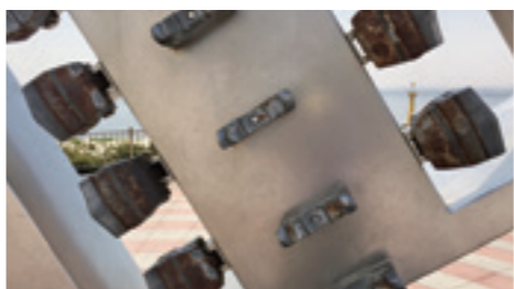
カッターフェイスに取り付けられたカッタービット
