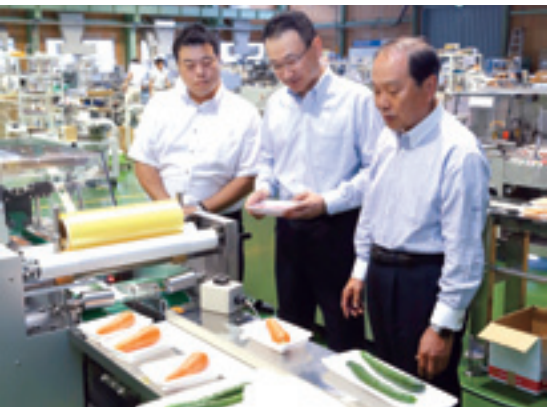
トレーにのった野菜が次々に自動包装される「ストレッチ型トレー包装機」
