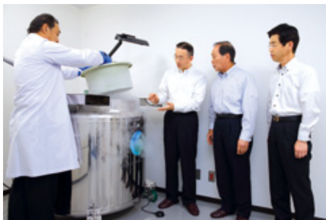
液体窒素を満たしたタンクで細胞を冷凍保管する
