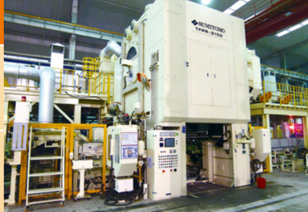
常州市の現地法人で導入した、3000トン級の大型プレス機を備えた自動化製造ライン
