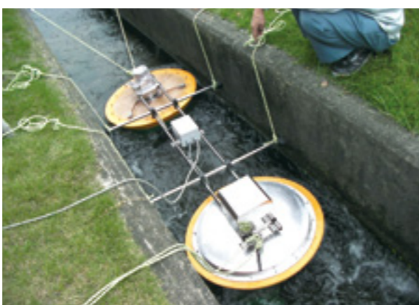
小水力発電装置「スピーンプロー」の実証実験
