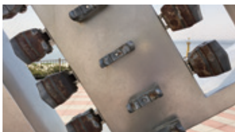
カッターフェイスに取り付けられたカッタービット
