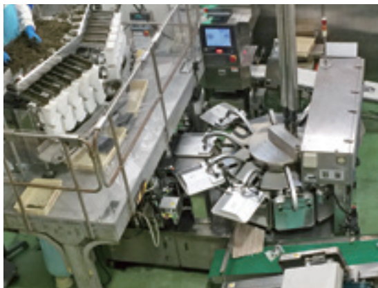
最先端の品質管理、X線検査装置と自動袋詰め工程
