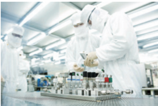
半導体用超精密バルブを製造する「ウルトラスーパークリーンルーム」
