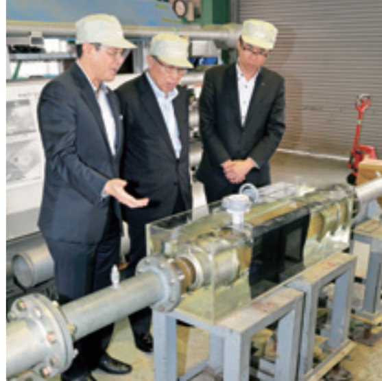
キャピテーション(空洞現象)を検証する実験設備
