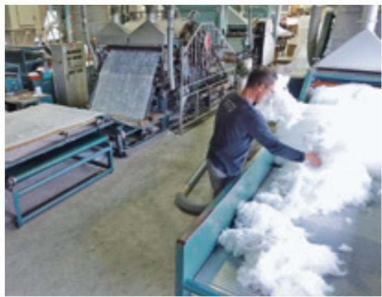
重量やサイズなどをもとに中綿を生産する製綿工程
