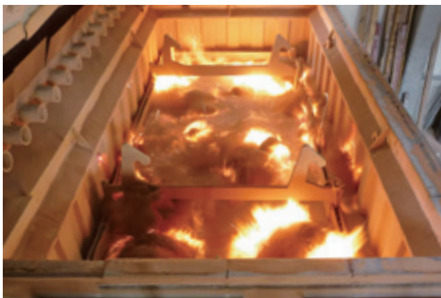
剥離処理能力が格段に高まった「流動床によるガス化システム」
