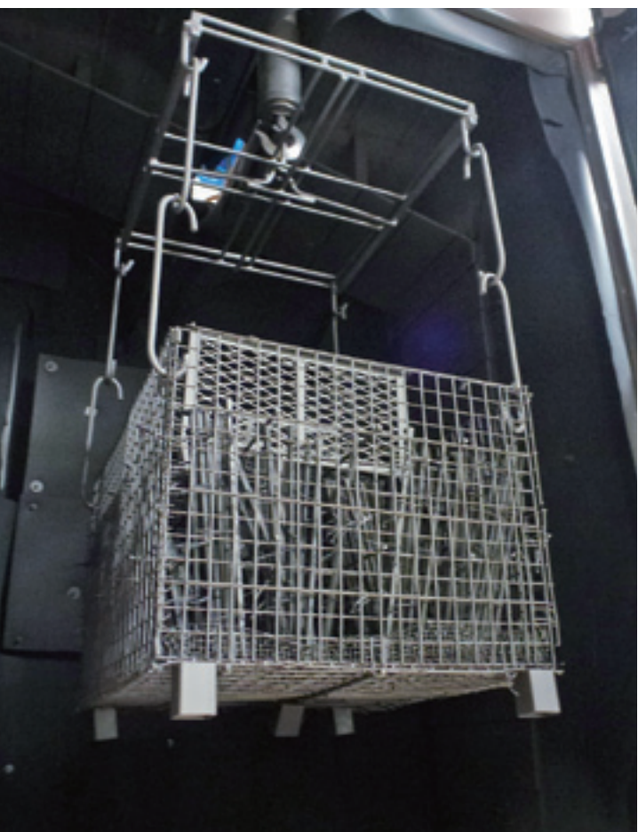
剥離処理した塗装用ハンガー
