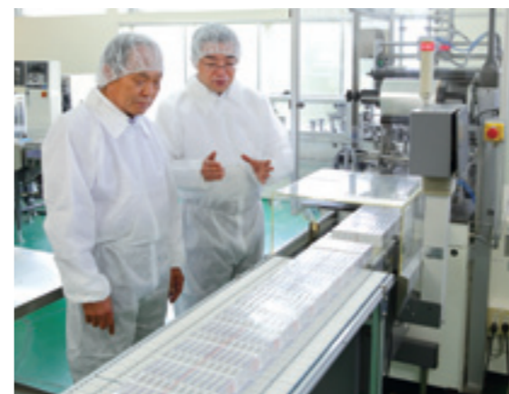
製品の品質を長く保つための錠剤の包装工程
