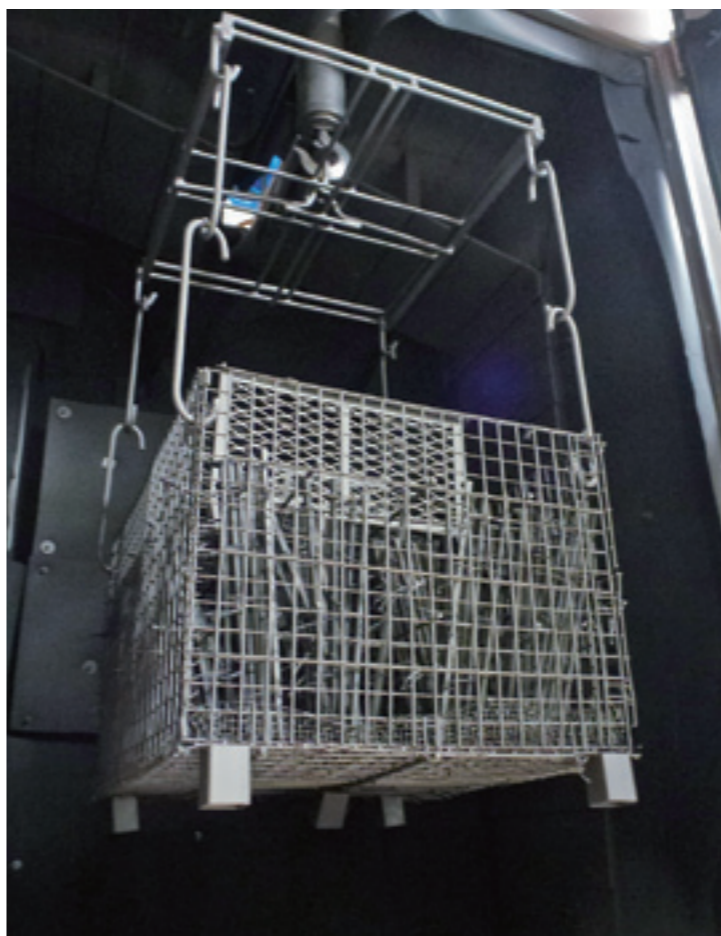
剥離処理した塗装用ハンガー
