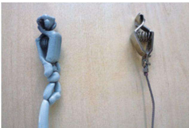
塗装剥離処理前(左)と処理後(右)
