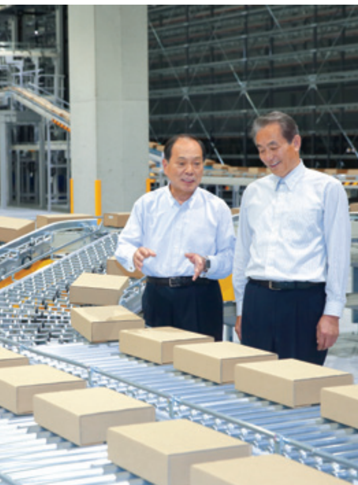
ピッキングゾーンから出荷ゾーンへ、自動的に貨物が流れる
