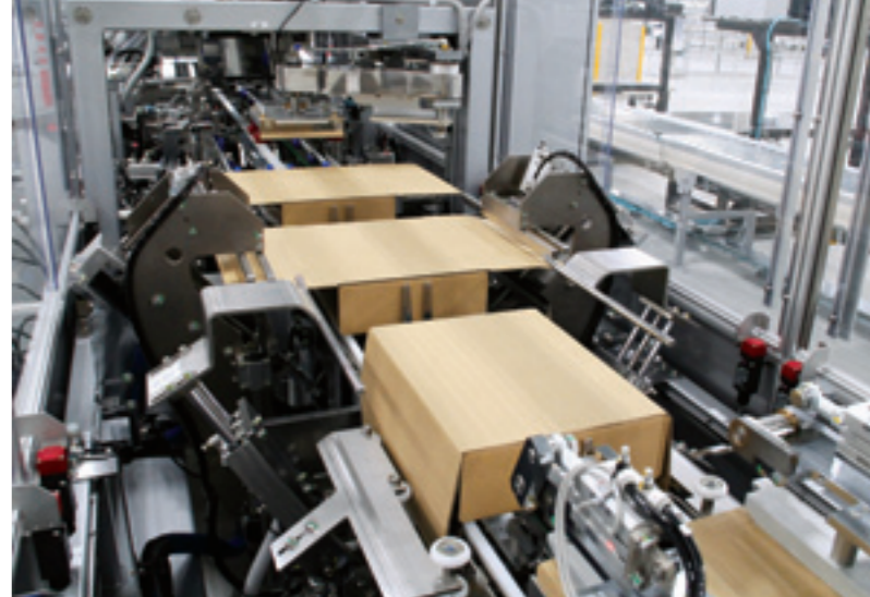
1時間に1,200個を梱包する自動梱包システム「ジェミニ」。板紙を組み立てて配送用に形成する
