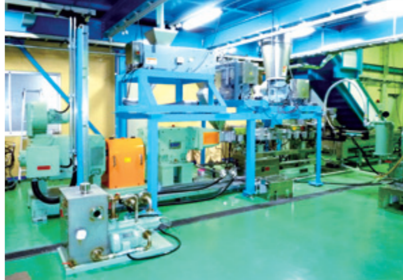
高品質の再生プラスチックを生産する、新導入の「2軸押出・造粒ライン」
