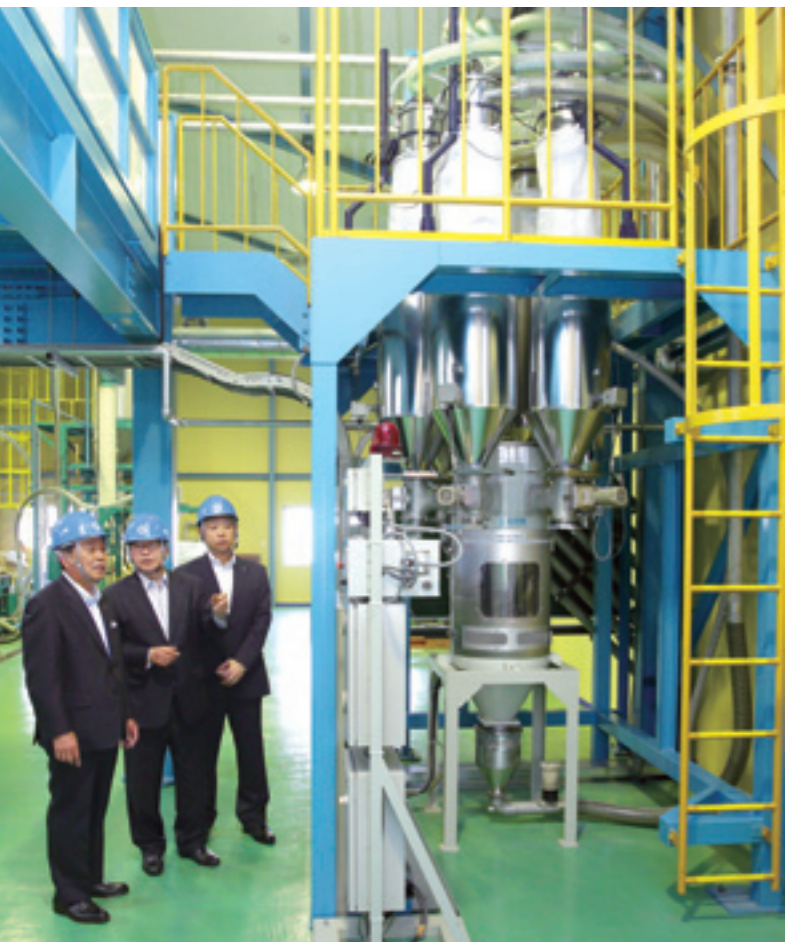
再生産される原材料を混合・計量・供給ライン
