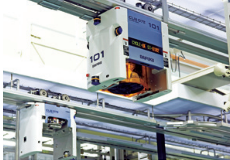
半導体向け搬送システム「クリーンウェイ」
