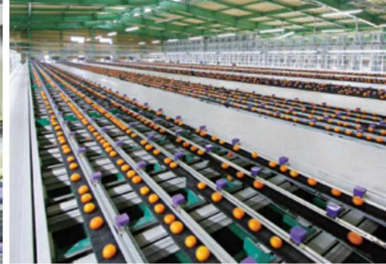
農産物選果システム「フィンガードミノソーター」によるミカンの仕分け
