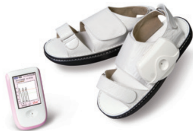
骨折リハビリのために開発された歩行分析計「ステップエイド」
