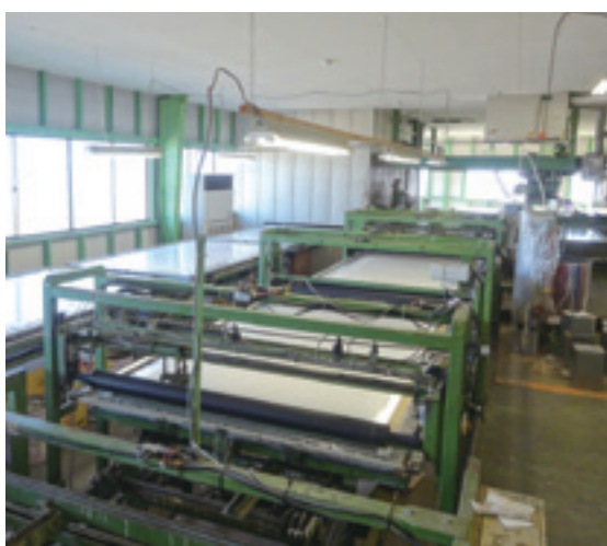
人手を掛けず、ポリフィルムをシワができないように張り合わせる
