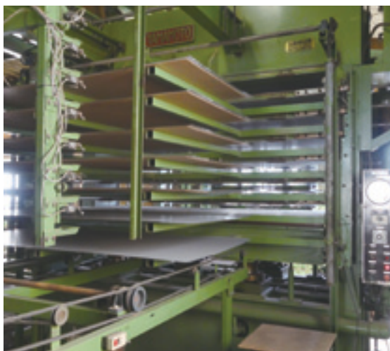
化粧紙を貼り、ホットプレスで熱硬化させる「自動紙貼りライン」
