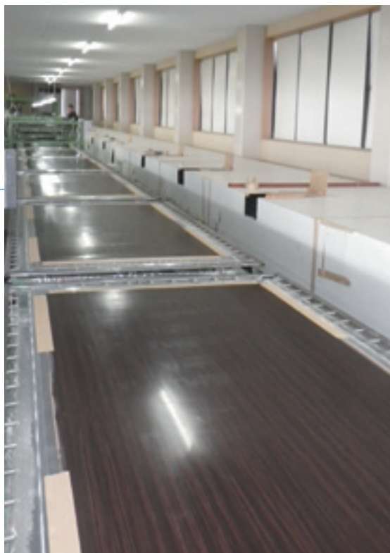
ポリエステル樹脂を合板に塗布する「自動ポリコートライン」
