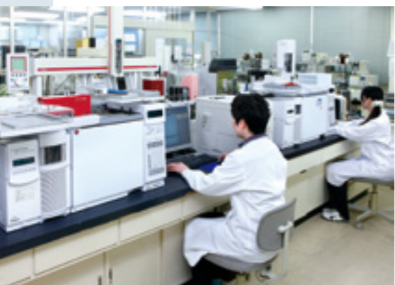
農業・シックハウス関連化学物質等を幅広く測定するGC/MS分析装置
