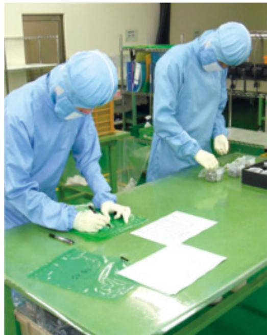
半導体洗浄装置の組み立てを行う、高い清浄度のクリーンルーム
