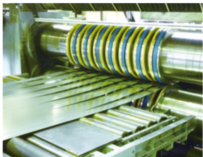
スリッターラインで鋼板を幅の狭いコイルに切断
