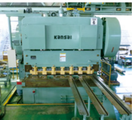
鋼板を必要な大きさにカットするシャリーングマシン
