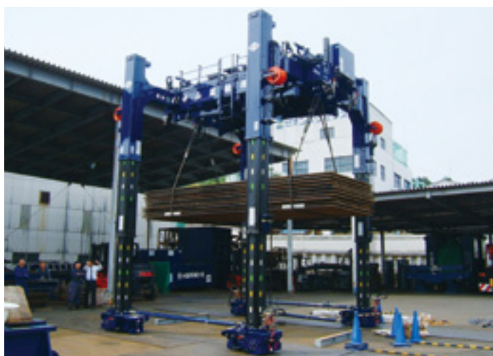
新型「60トン走行リフター」。コンパクトにたたんで15トントラックで運搬できる
