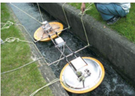
小水力発電装置「スピーニング」の実証実験
