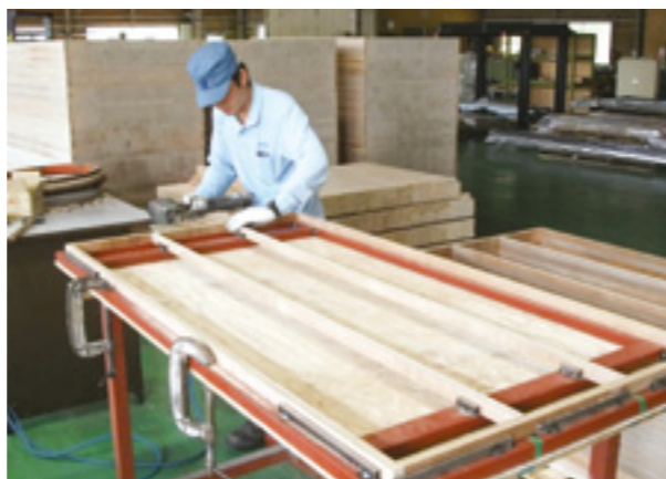
住宅部材の組み立て作業風景
