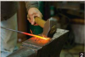
炉から出して叩いた鉄を型にはめて曲げ、金床で叩いて微調整する。鉄は熱いうちなら子どもでも簡単に曲げられるほど柔らかい(写真3)。
