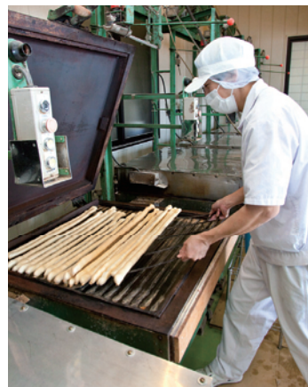
熟練の職人が手でひとつひとつ約200℃の鉄板に伸ばし、11~12分ほど焼いて棒状の焼麩にする。
