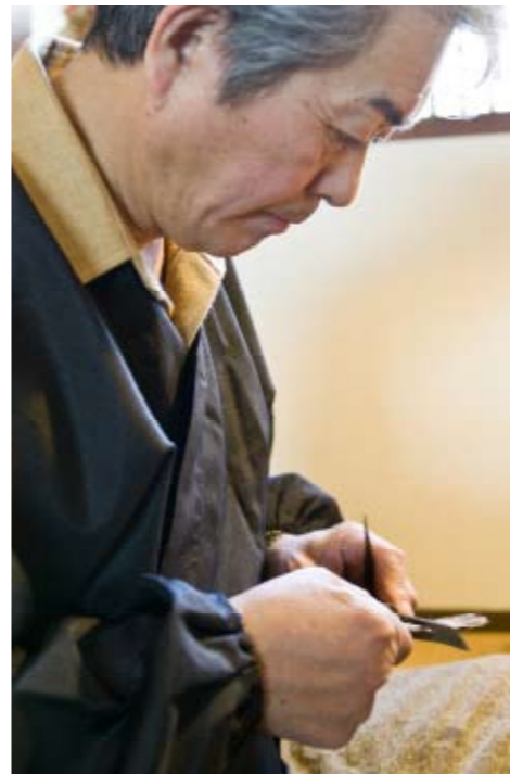
櫛やハンサン(筆づくり用の小刀)を使って逆毛、すれ毛などを取り除き、毛先を揃えて芯毛をつくる「芯立て」と呼ばれる作業。職人の熟練した技術が求められる。
