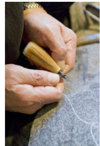
乾燥させた芯毛のまわりに上毛(化粧毛)をかけてさらに乾燥させ、根元に焼きゴテを当てて、五寸釘を使って穂首を麻糸で締め固める「尾締め」という作業。
