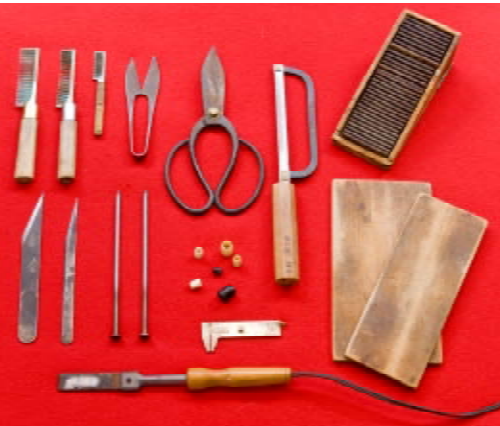
筆づくりに使用される道具一式。上段左から櫛、ハサミ、ノコギリ、寸規(すんぎ、毛の長さを揃える定規)、下段左からハンサン(小刀)、五寸釘、コマ(筆の太さを調整する枠)、揃板、その下が焼きゴテ。
